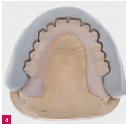
Abb. 18 Einbetten des Kunststoffdummys mit Knetsilikon (95 Shore).
