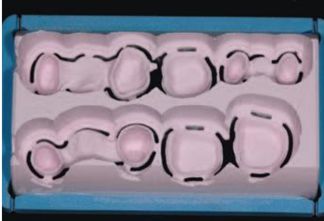
Abb. 3 Die Fräsobjekte werden in einen Rohling (Cercon base colored) eingepasst, wobei die Software Cercon art behilflich ist.
